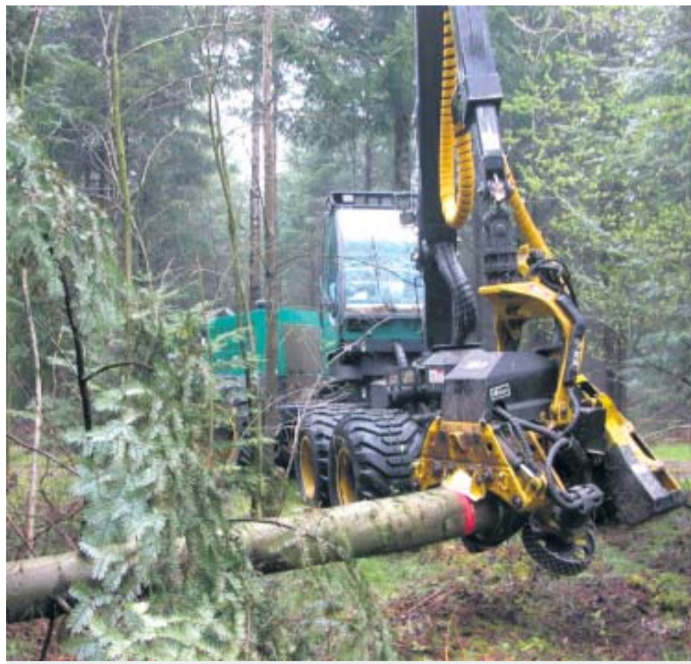
Mit einer solchen Holzerntemaschine Typ „Harvester“ werden die Bäume gefällt.
